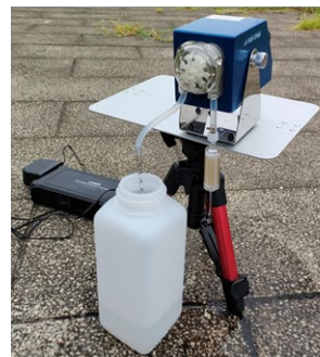
現場ろ過の様子
