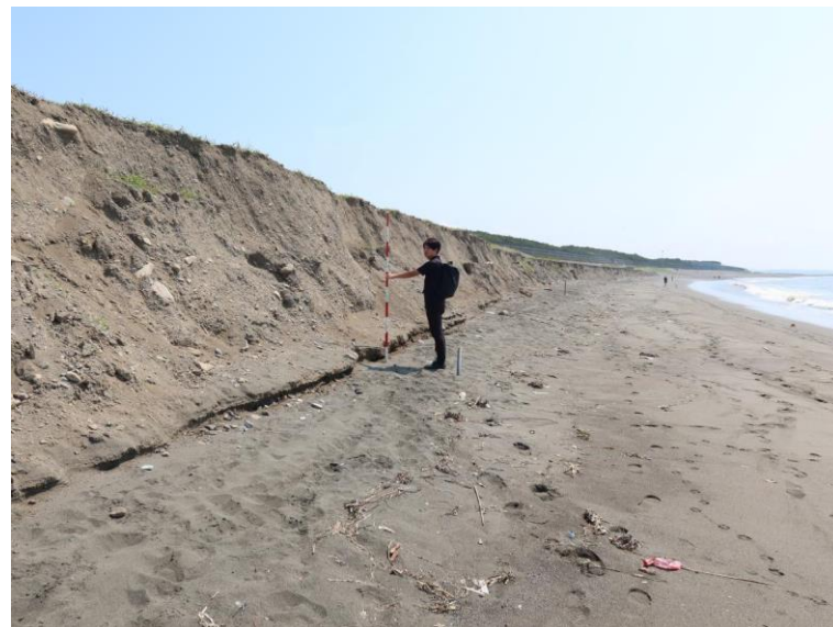
写真-1 盛り土養浜前面の浜崖と前浜の状況
