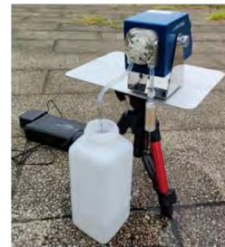
現場ろ過の様子
