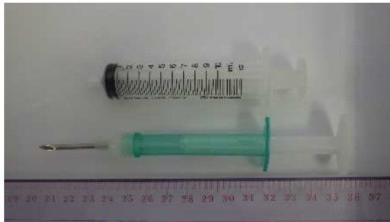
図1 10mL シリンジと針 (PIT タグ用インジェクター)
