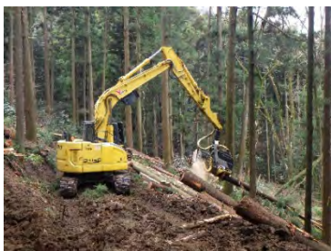
高性能林業機械（ハーバスタ）を利用した伐木作業の様子
