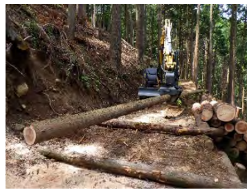
高性能林業機械（ウインチ付きグラップル）を利用した集材作業の様子
