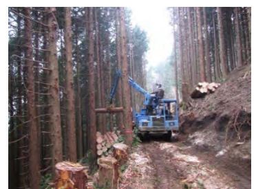
高性能林業機械（フォワーダ）による運材作業の様子
