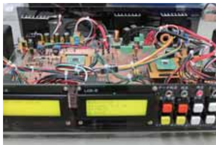
PIC32とMP3デコーダを用いた オーディオプレーヤーの製作
