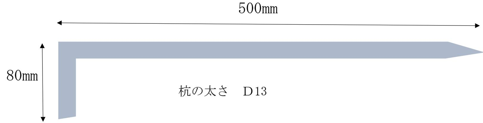
※ 5 鉄筋杭L型 D16×80×600 四面タタキ (先端尖らす)
