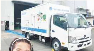
停電したポンプ所に電気を供給する電源車
