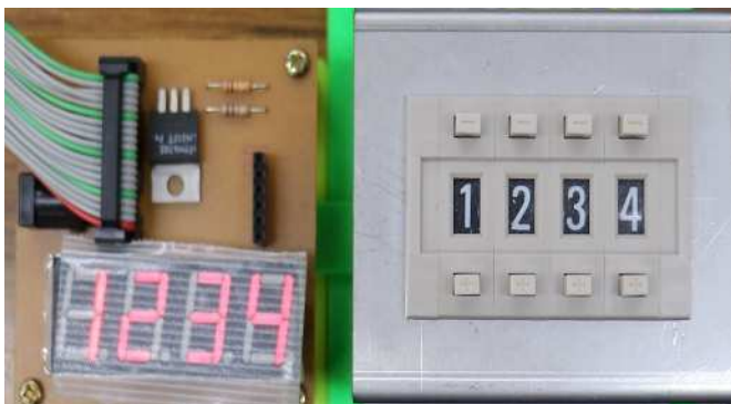
4桁のデジタル表示器と デジタルスイッチ
