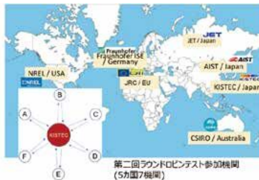
図1 第二回国際ラウンドロビンテスト参加機関とハブ・アンド・スポーク方式概略図
