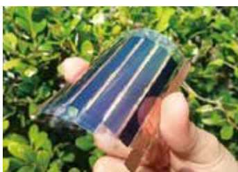
フィルム型のペロブスカイト太陽電池モジュール
