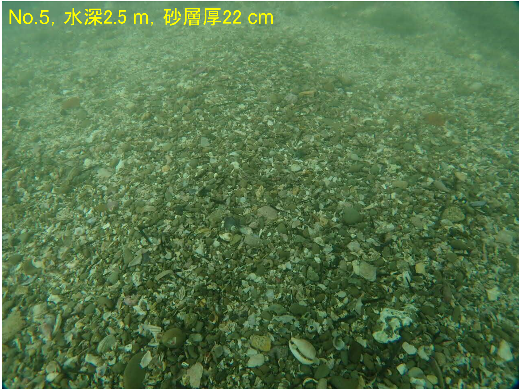
写真-8 No.5での海底状況 海底には大量の貝殻片や円礫が堆積.
