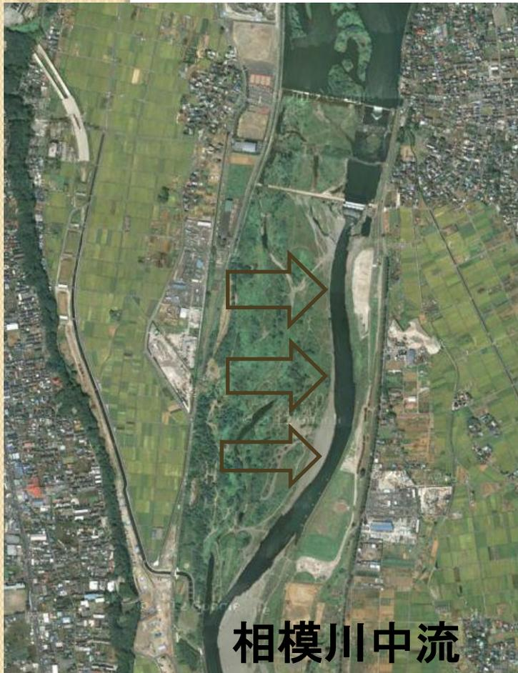
高水敷を切り下げて滞筋の埋め戻し
