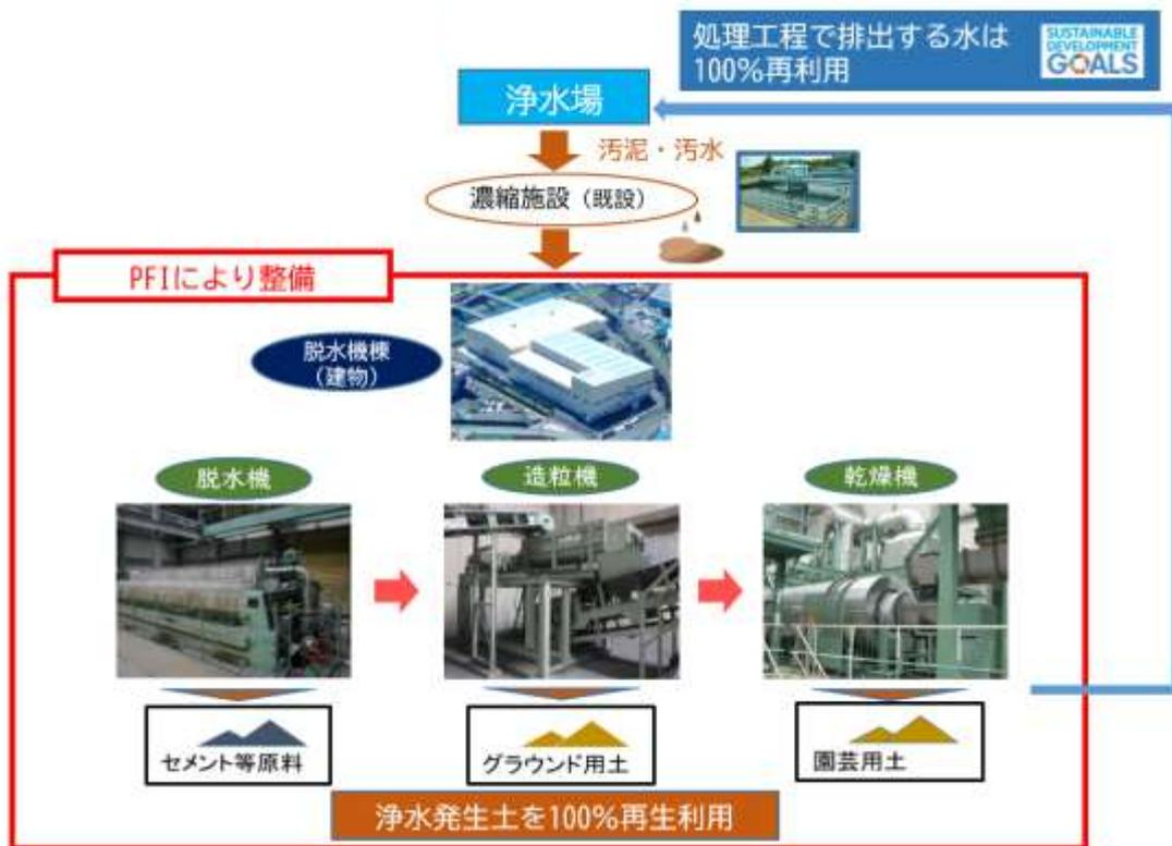
図 排水処理施設の概要
