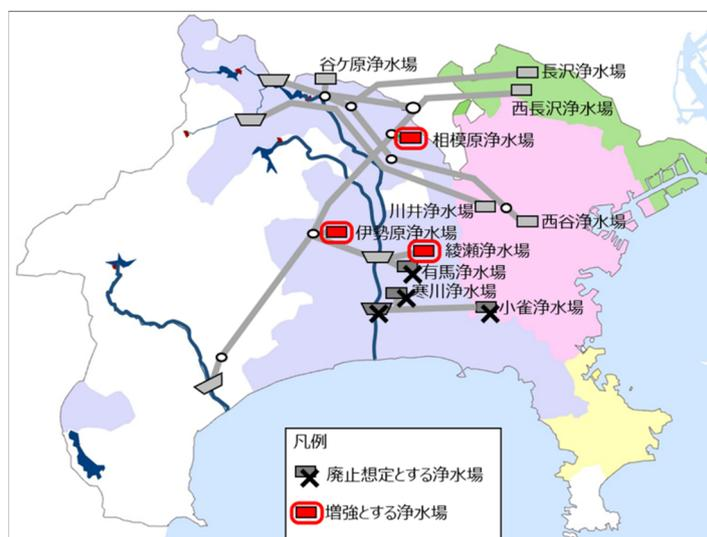
図 浄水場の再編（ダウンサイジング）
