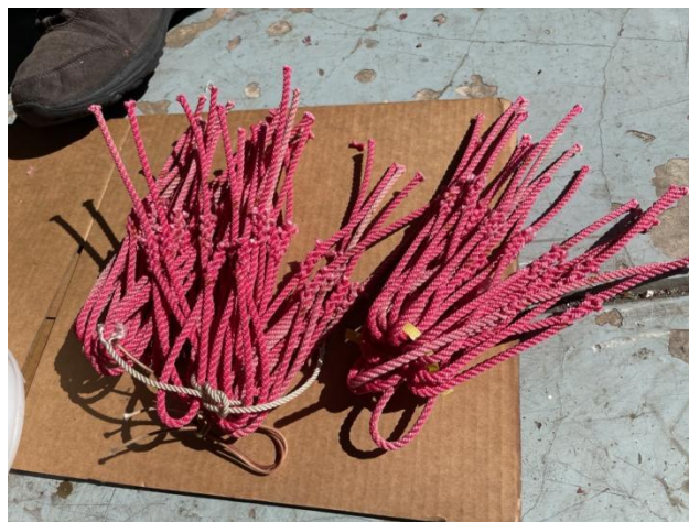
枝縄を幹縄に取り付ける箇所の部分。編み込んで輪を作製しています。
