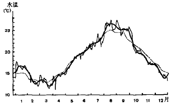
図5 1966～1977年の旬平均水温変化(点線), 1971年1～12月の日平均水温変化(細線)とフーリエ級数から求めた水温変化(太線)
