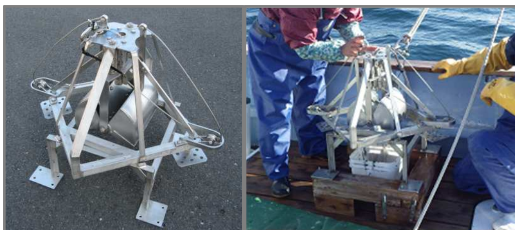
図2 スミスマッキンタイヤ採泥器(採泥面積0.05m 2 )
