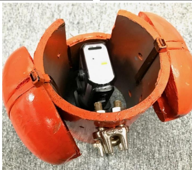
図5 採泥器上部へ取り付けられた小型カメラ
