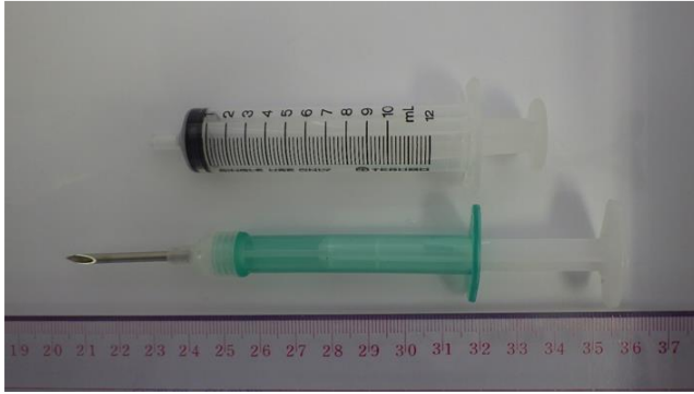
図1 PIT タグの専用インジェクターと10mL シリンジ
