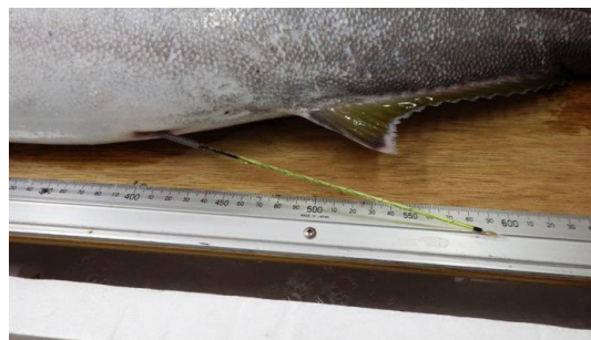
図5-6 装着されたアーカイバルタグのアンテナ
