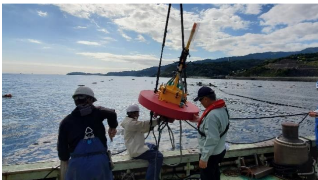
定置網のスマート化（魚群探知機を搭載したブイ）
