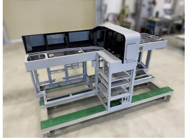
設備写真：鉄道車両の運転台
