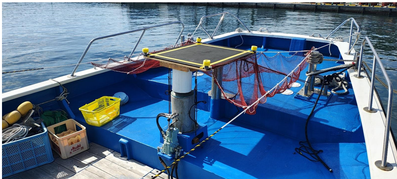
図5 調査船に取り付けたほうじょう船員お手製の離着陸用ドローン用お立ち台（試作）
