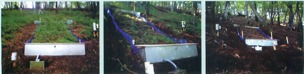
写真3 土壌侵食量調査の調査区の様子 (左：林床植生植被率大 中：植被率中 右：植被率小)
