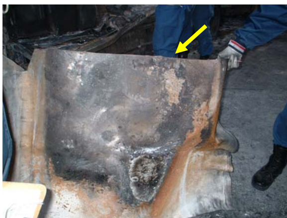
c. 破裂した50kg容器の銅板
