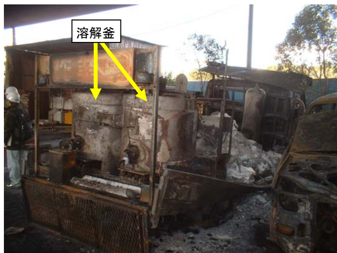
a. 焼損した道路区画線溶解車(左)と連絡車(右)
