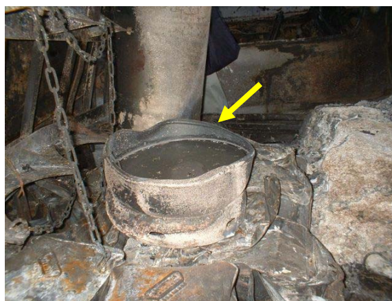
d. 破裂した50kg容器の鏡板
