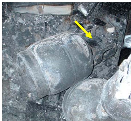
b. バルブが溶けた容器 (車載のLPガス5kg容器)
