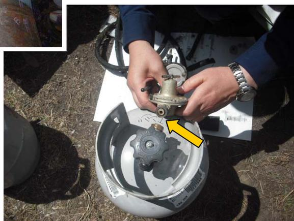
c. 減圧弁の継手の折損状況
