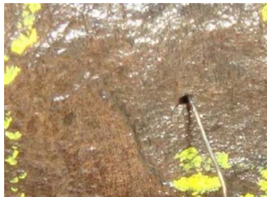
図5 孔食の拡大写真
