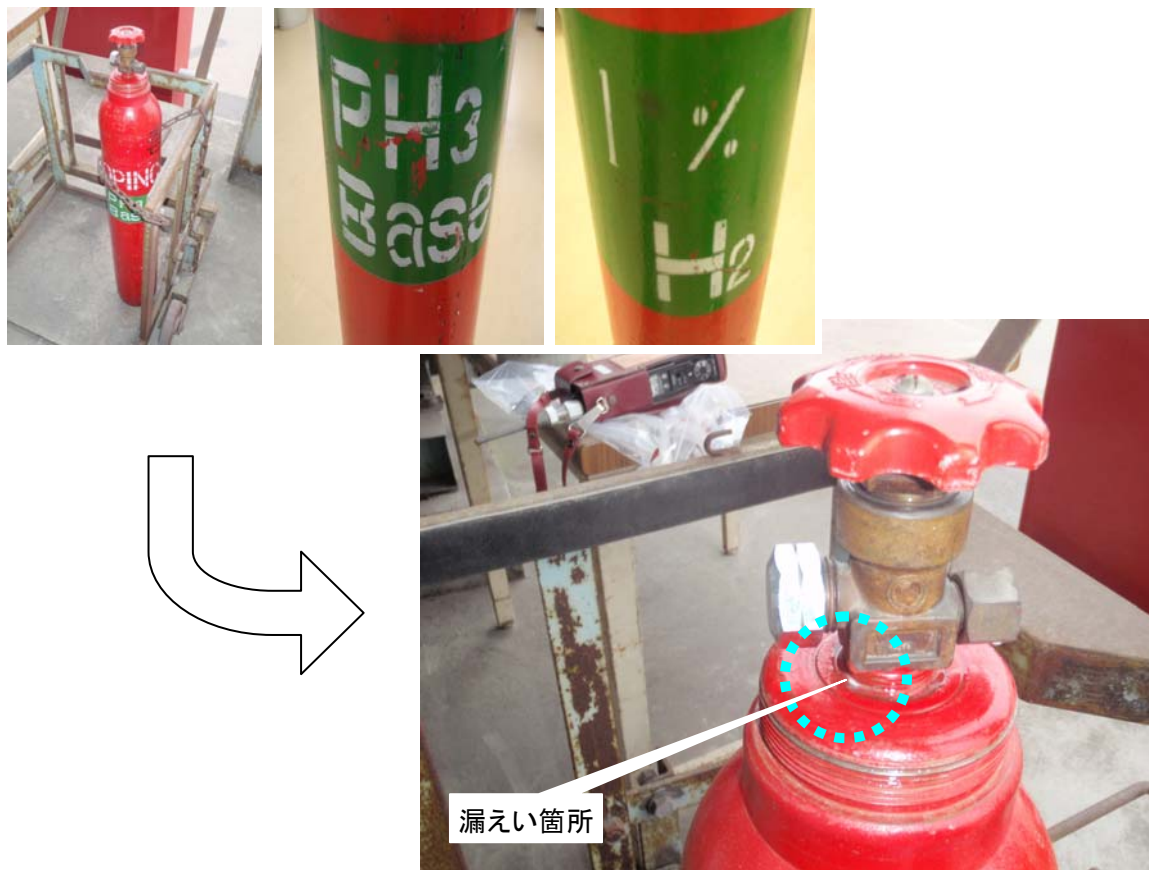
図2 漏えいを起こした容器Bの外観と漏えい箇所の写真
