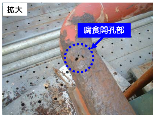
図2 配管漏えい箇所 (保温材を取り外し、 錆削り後の状況)
