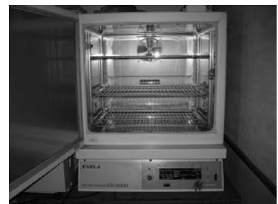
図2-2-3 低温インキュベーター（EYELA LT1600D）による低温耐性試験の状況
