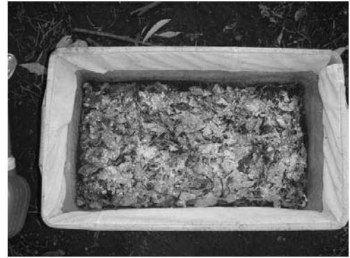
図 3-1-10 薬剤の表面散布効果試験の様子(薬剤が表面に白く見える)
