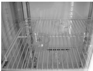
図2-2-2 グローブチャンバー（MLR351-H）による高温耐性試験の状況
