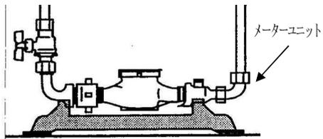
10 について； 口径 50mm 以上の大型水道メーターを取り扱う場合は特に注意し、「メーター部」と「ストレーナ部」を離して運搬すること。
