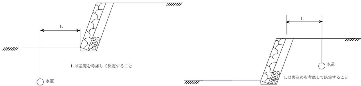
2について； 道路に給水管を配管する場合は、ガスパイプ、通信ケーブル、電気ケーブル、下水管等の埋設物に十分注意し、道路管理者が定めた占用位置に配管すること。
