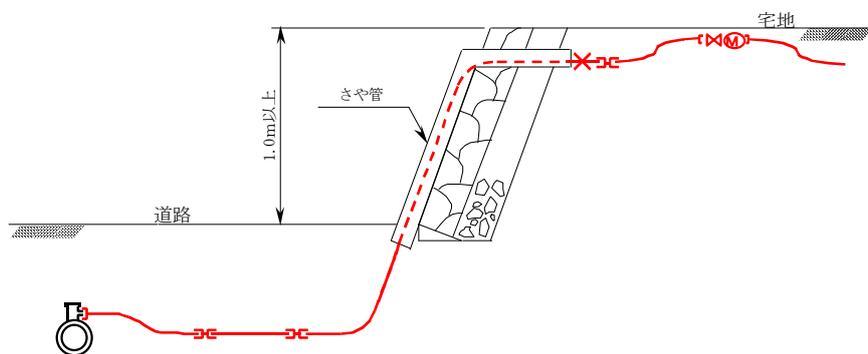
6について； この工法では、給水管を直接押し込まず、布設する給水管口径より大きい口径で貫孔した後に鞘管を挿入し、鞘管内に給水管を布設すること。また、鞘管内の給水管は継手をなるべく少なくし、防食テープを巻き付け、その後にポリエチレンスリーブを取り付け布設すること。なお、施工場所の土質・障害物等事前調査を十分に行うこと。
