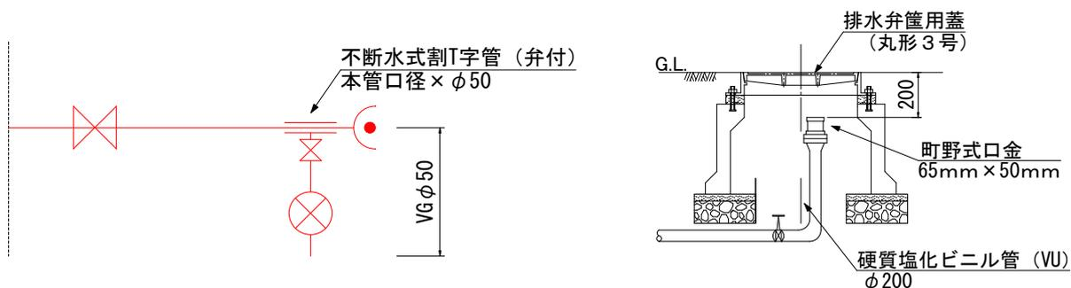
図 5-6-9-2 排水管標準配管図（給水口付空気弁）
