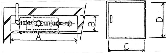
3について； 水道メーターは、埋没や外部からの衝撃等を防護するとともに、その位置を明らかにするため、メーター筐（室）を付帯させて設置すること。仕様は、3・16・3「指定範囲における材料の選定」に準じる。サイズは、メーター口径に応じたものとし、3階直結直圧式給水などでメーター下流側に逆止弁を設置する場合は1ランク上のサイズを選定し、逆止弁が筐内に収まるよう設置する。ただし、ボックス一体型のメーターユニットを採用する場合は、この限りではない。
