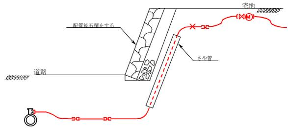
図5-6-6 高低差が1m以上あり露出配管する場合
