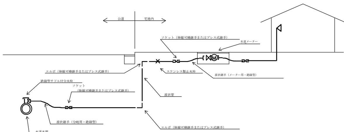
図5-6-2 標準配管例 (φ50 mm)
