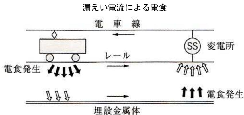
また、他の埋設金属体に外部電源装置、排流器による電気防食を実施したとき、これに近接する他の埋設金属体に防食電流の一部が流入し、流出するところで侵食を引き起こすことがある。これを干渉による電食という。
