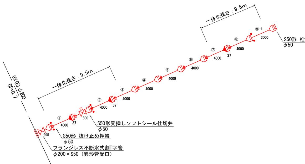
図2 配管例（口径75mmからS50形を配管）
