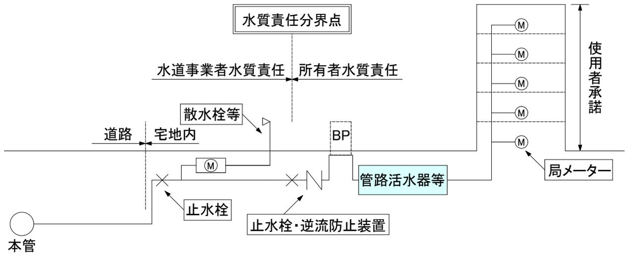
※ 直結増圧給水に活水器等を設置する場合は、増圧ポンプの下流側とし、原則として共用メーター、止水栓（バルブ）、逆止弁の設置は兼用できるものとする。
