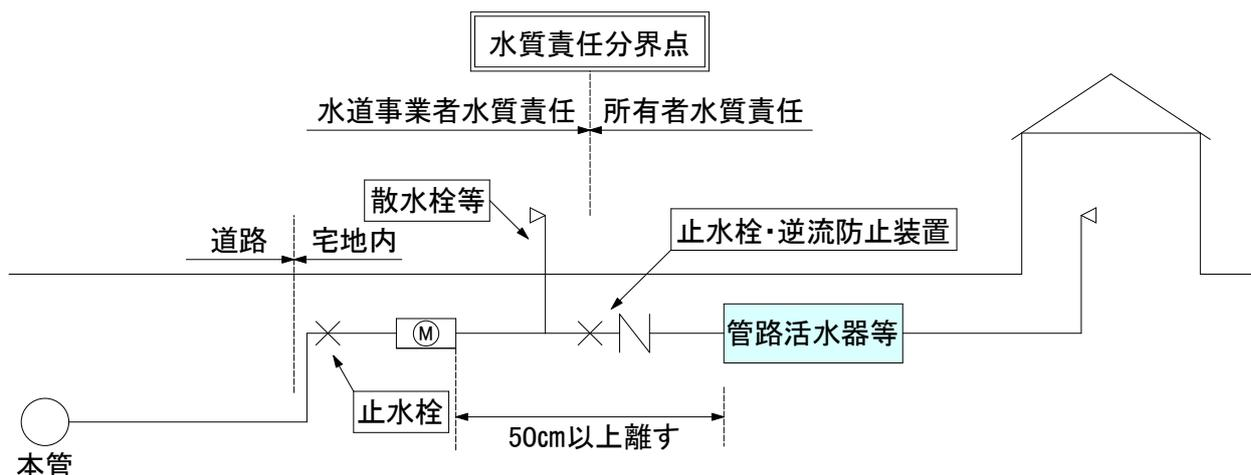
※ 完了検査時及び通常の水質の検査等は、原則として管路活水器等の上流側の水栓にて行う。また、管路活水器等の上流側の水栓は、管路活水器等の異常、メンテナンス、修理時等において、飲用水の確保に利用する。
