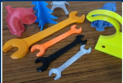
3次元データの形状検証のために、3Dプリンターでモデルを製作します。
