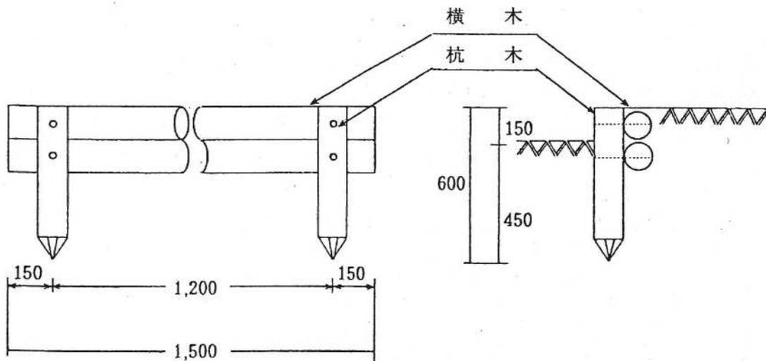
シ 丸太柵工（鉄筋杭）、丸太筋工（鉄筋杭）
