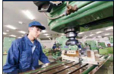
主に四角い形状の精密部品を加工するための機械操作を習得します
