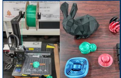
3次元モデルの形状検証のため、3Dプリンタで製作する技術を習得します
