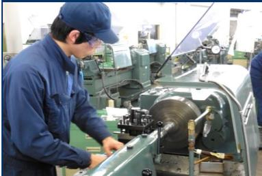
主に円筒形状の精密部品を加工するための機械操作を習得します
