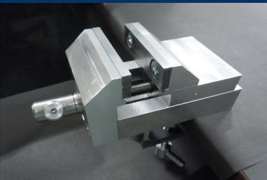
汎用工作機械(普通旋盤、フライス盤)を使用し、ミニバイスを製作します
