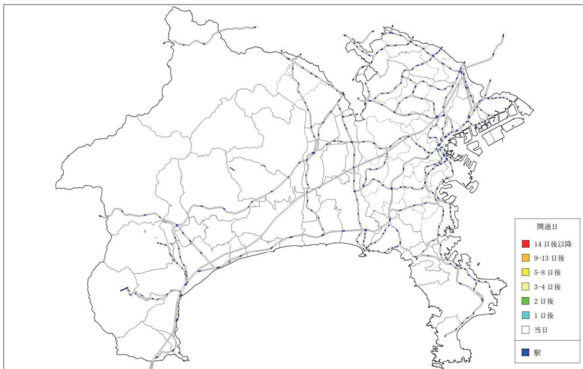
図 3.82 南海トラフ巨大地震（東側ケース）の鉄道の復旧日数の想定結果（耐震化を考慮しない場合）
