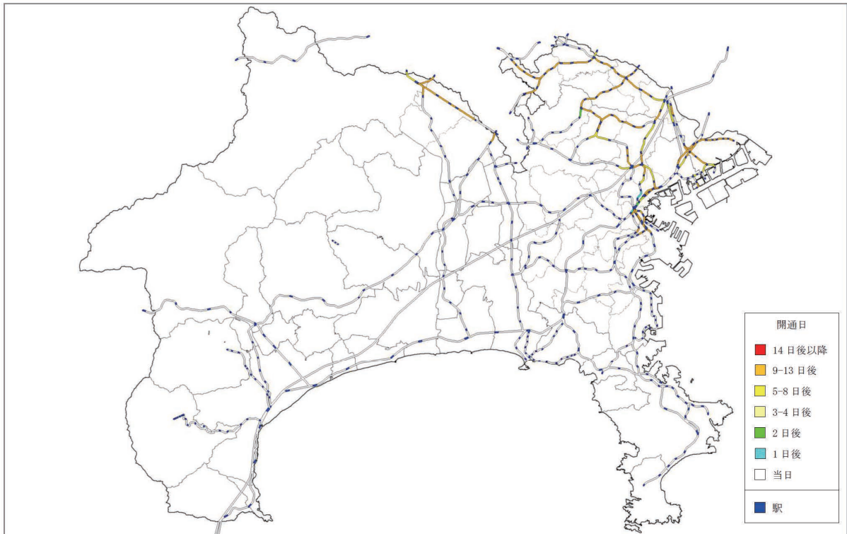
図 3.78 都心南部直下地震の鉄道の復旧日数の想定結果（耐震化を考慮しない場合）
