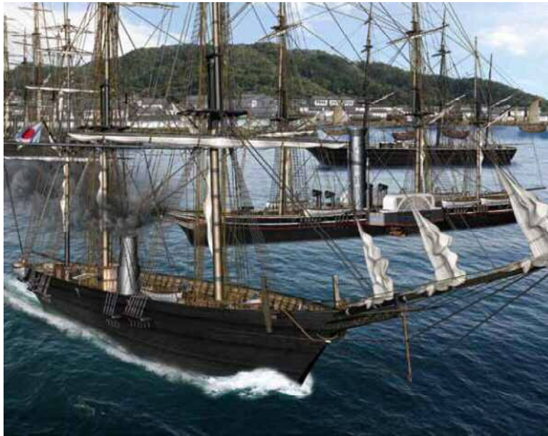
咸臨丸は全長48.8m、全幅8.74m、排水量625tの木造スクルー蒸気船。日本人96人を乗せて浦賀港を出港。荒波や船酔いなどと共に航海。乗っていた幕臣の鈴藤晋次郎がその様子を絵にしている。福澤諭吉やジョン万次郎も乗船していた（CG成瀬京司）
