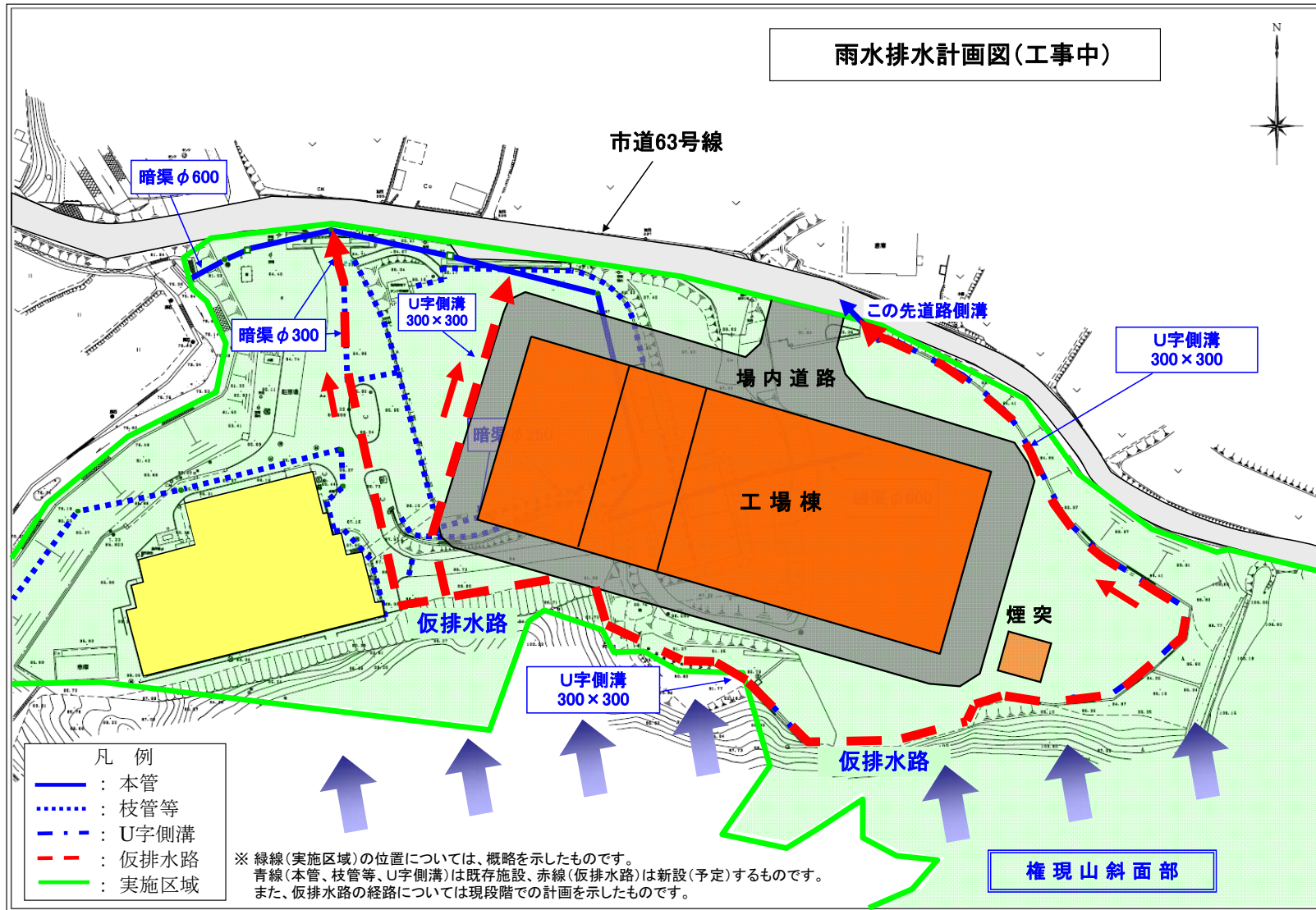
図4-2-2 工事中における雨水排水計画図
