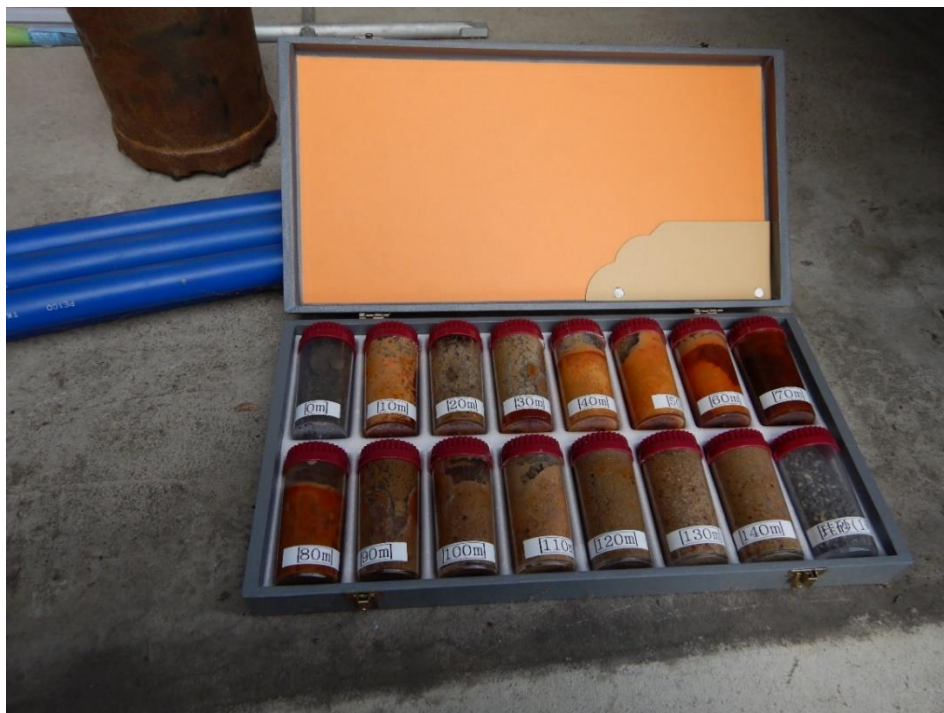
地中熱を利用するために地下を掘った時の地層のサンプル
