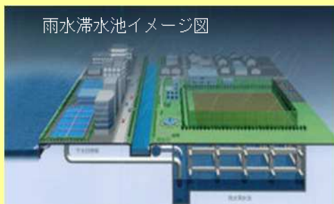
図15 合流式下水道の改善内容
