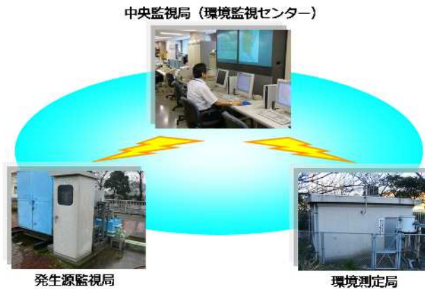
図 16 テレメータシステムの例（横浜市）
