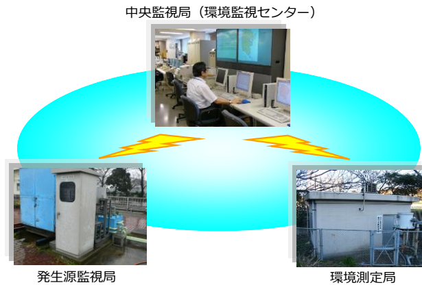
図 16 テレメータシステムの例（横浜市）
