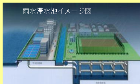
図15 合流式下水道の改善内容
