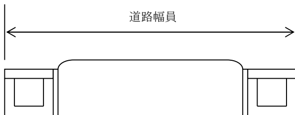
第8図 U字型側溝の場合
