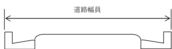
第9図 L字型側溝の場合
