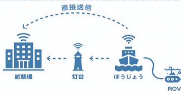
図10 水中ドローン（ROV）で録画した映像を漁業調査船からアクセスポイント（漁港入口の灯台）経由と直接送信で試験場へ送信する通信試験を行いました（イメージ図）
