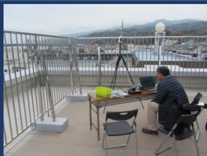
図11 相模湾試験場屋上にアンテナを設置して通信試験を実施
