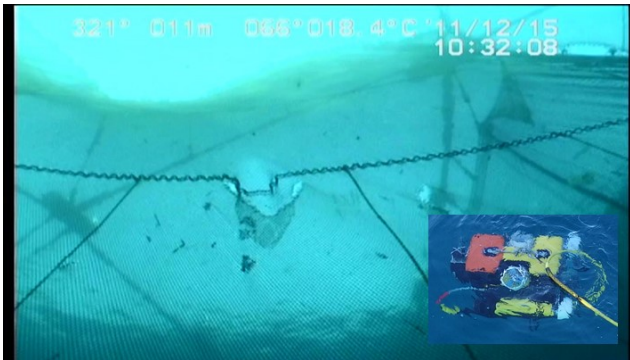
図7 ROVで定置網の状況調査
