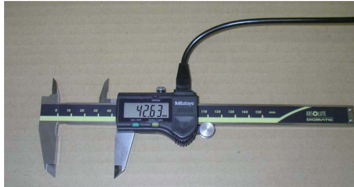
デジタルノギス（パソコン接続ケーブル付き） 測定結果が自動でパソコンに送られます
