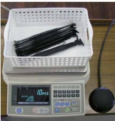
カウント機能付き電子天秤と入力用の外付けボタン (製品を 10 個乗せると 10 pcs と表示されます)
