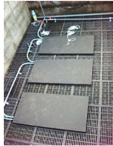
図1 擬似豚舎内の温湯マット設置状況
