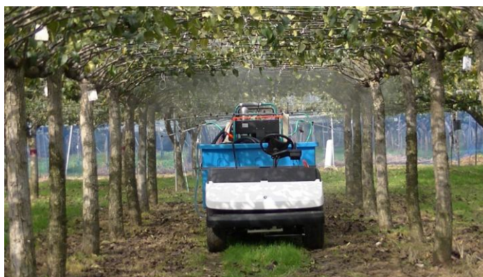
図5 農薬を浴びず散布労力を軽減するジョイント樹形用自動防除機
