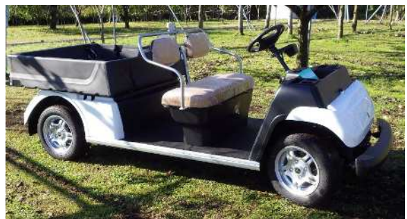
図2 ゴルフカートを利用した自動走行車両の試作品
