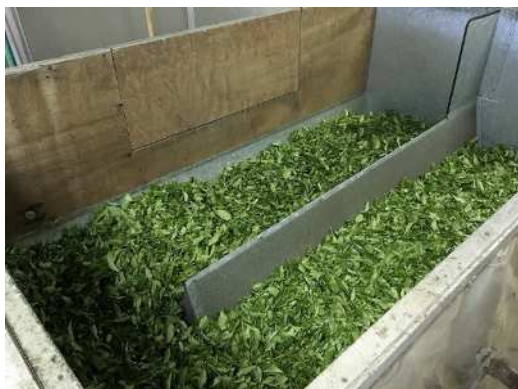
図9 一般的な通風発酵工程の様子
