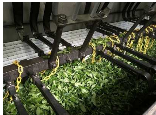
図10 荒茶製造ラインの温風を使った効率発酵
